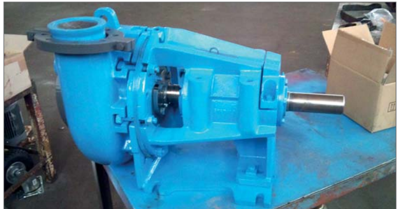
Reparación bomba Svedala MM150
