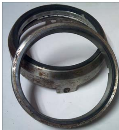
Reparación cierre Latty doble Ø155mm (Equipo Gyroclean)
